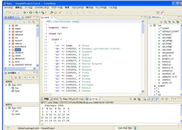
TurboRubyのスクリプト・エクスプローラー上で実行したいモジュールを選択し、「Rubyスクリプトの実行」により、例えば、コマンドラインから以下のコマンドを実行した際と同じ結果が得られます
